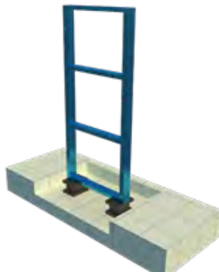
Gambar 8. Ilustrasi struktur yang diberikan isolation bearing
