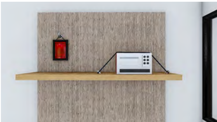
Gambar 7. Komponen non-struktur harus diberi pengaku
