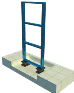
Gambar 8. Ilustrasi struktur yang diberikan isolation bearing
