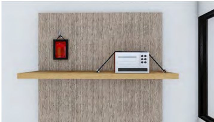
Gambar 7. Komponen non-struktur harus diberi pengaku
