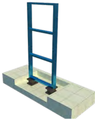
Gambar 8. Ilustrasi struktur yang diberikan isolation bearing
