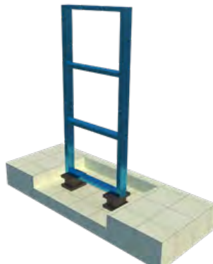
Gambar 8. Ilustrasi struktur yang diberikan isolation bearing
