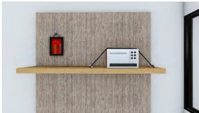
Gambar 7. Komponen non-struktur harus diberi pengaku
