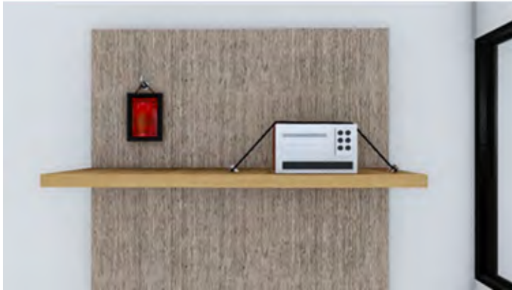
Gambar 7. Komponen non-struktur harus diberi pengaku
