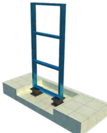
Gambar 8. Ilustrasi struktur yang diberikan isolation bearing
