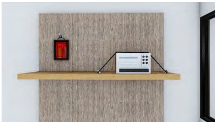
Gambar 7. Komponen non-struktur harus diberi pengaku
