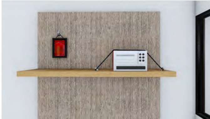
Gambar 7. Komponen non-struktur harus diberi pengaku
