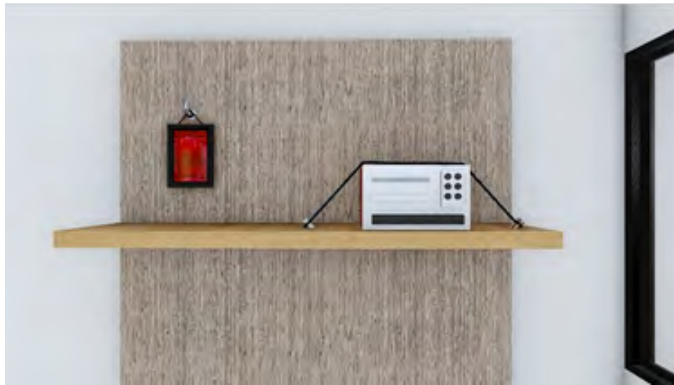
Gambar 7. Komponen non-struktur harus diberi pengaku
