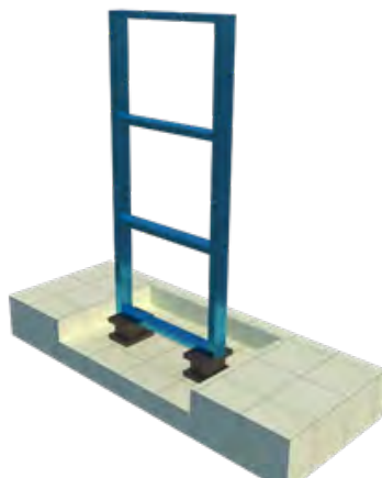
Gambar 8. Ilustrasi struktur yang diberikan isolation bearing
