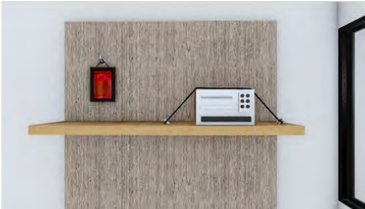
Gambar 7. Komponen non-struktural harus diberi pengaku
