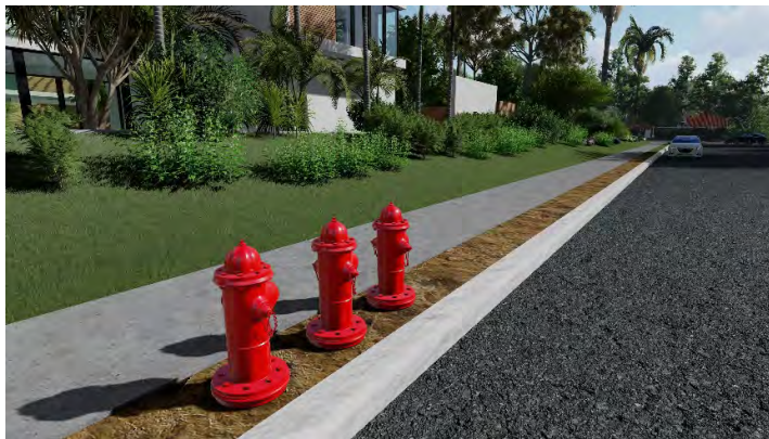
Gambar 9. Ilustrasi penempatan sistem hydrant lingkungan
