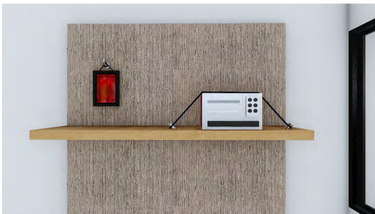
Gambar 7. Komponen non-struktur harus diberi pengaku
