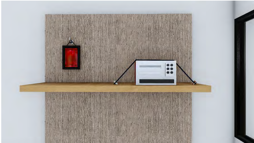
Gambar 7. Komponen non-struktur harus diberi pengaku
