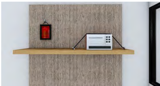
Gambar 7. Komponen non-struktur harus diberi pengaku
