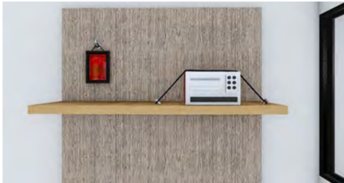
Gambar 7. Komponen non-struktur harus diberi pengaku
