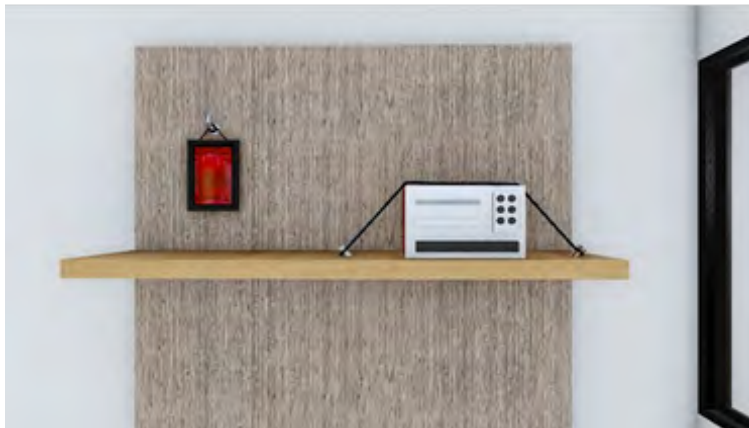
Gambar 7. Komponen non-struktur harus diberi pengaku
