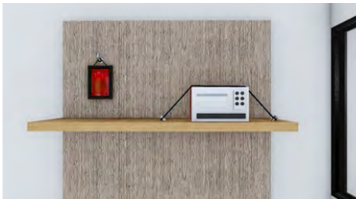
Gambar 7. Komponen non-struktural harus diberi pengaku
