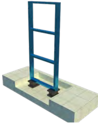
Gambar 8. Ilustrasi struktur yang diberikan isolation bearing
