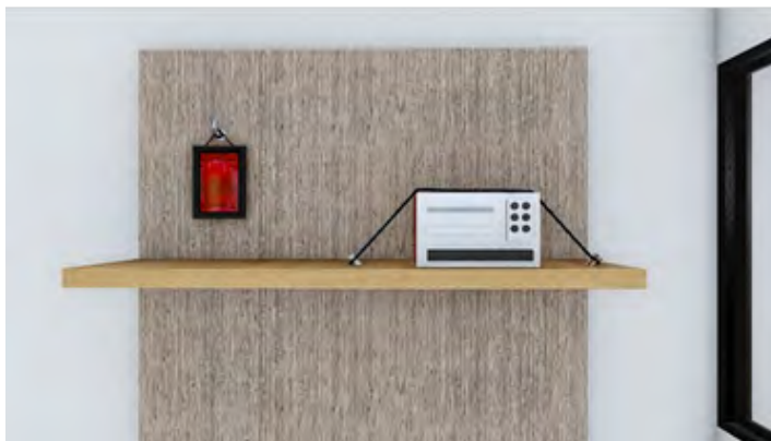
Gambar 7. Komponen non-struktural harus diberi pengaku
