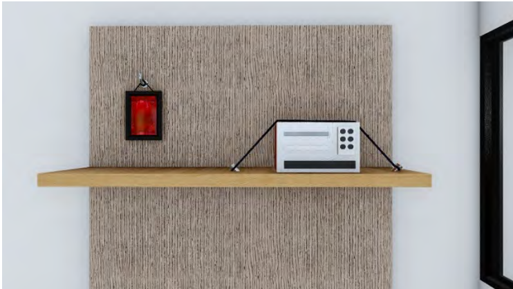
Gambar 7. Komponen non-struktur harus diberi pengaku
