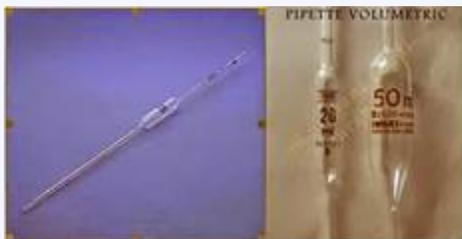
Digunakan untuk mengambil larutan dengan volume tertentu sesuai dengan label yang tertera pada bagian pada bagian yang menggebu.
