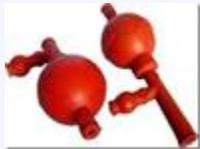
Karet penghisap berfungsi untuk menghisap larutan yang akan dari botol larutan. Untuk larutan selain air sebaiknya digunakan karet pengisat yang telah disambungkan pada pipet ukur.
