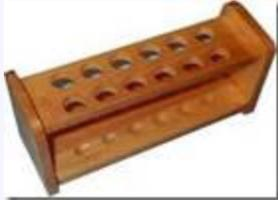
Fungsi rak tabung reaksi adalah sebagai tempat tabung reaksi. Biasanya digunakan pada saat melakukan percobaan yang membutuhkan banyak tabung reaksi. Numun dalam mereaksikan zat yang menggunakan tabung reaksi sebaiknya menggunakan rak tabung reaksi demi keamanan diri sendiri maupun orang lain.
