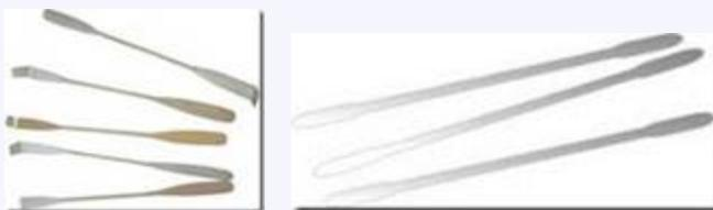
Spatula digunakan untuk mengambil bahan-bahan kimia dalam bentuk padatan, misalnya dalam bentuk kristal. Untuk zat-zat yang bereaksi dengan logam digunakan spatula plastik sedangkan zat-zat yang tidak
