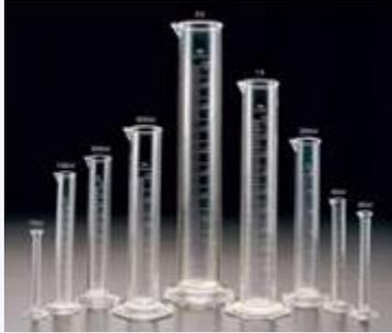
Fungsi Gelas ukur adalah untuk mengukur volume larutan yang tidak memerlukan ketelitian yang tinggi dalam jumlah tertentu.
