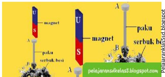
Gambar 5.4. Magnet dengan cara induksi
