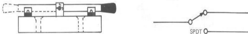
Gambar 5. Gambar dan simbol sakelar SPDT
