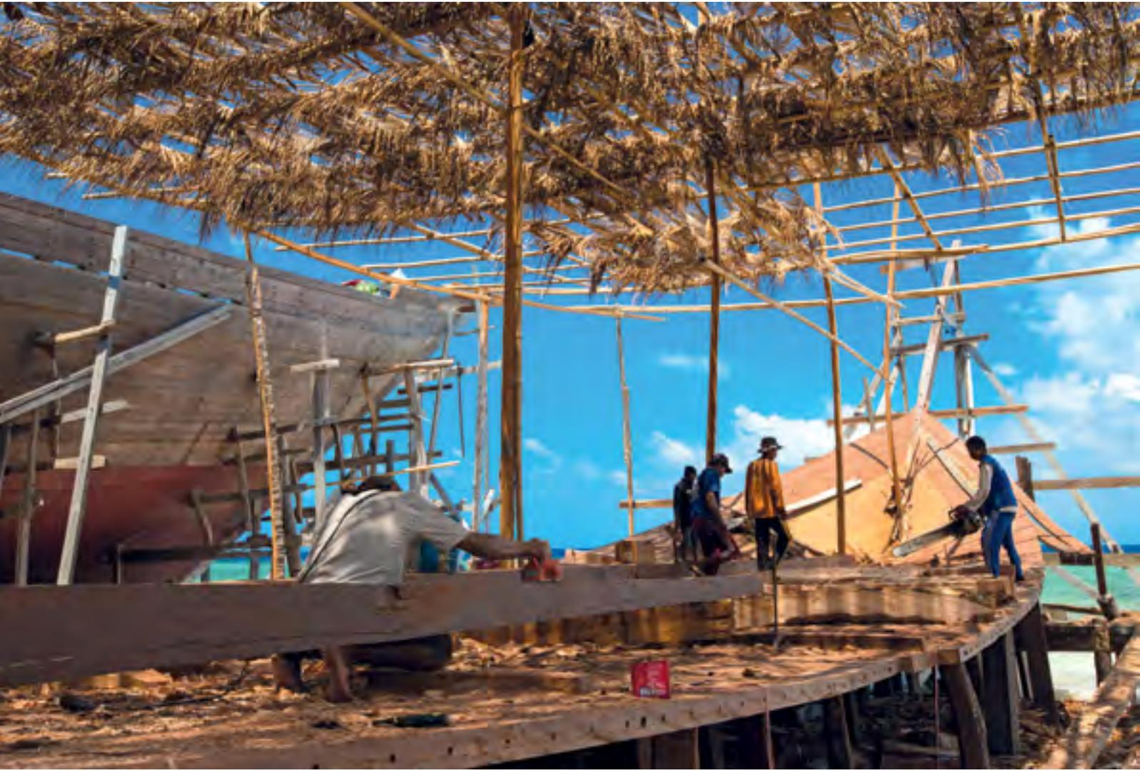
⚡ Pemasangan dinding rangka atau papan pengapit lunas. Penyusunan papan dilakukan dari bawah dengan ukuran lebar yang terkecil sampai ke atas dengan ukuran terlebar.
