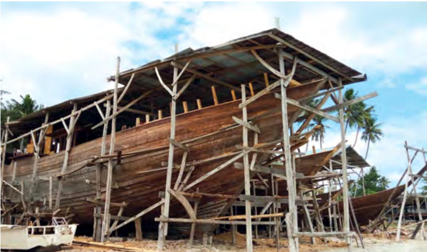
— Pembuatan pinisi dilakukan dengan membuat kulit lambung dahulu baru dilanjutkan dengan rangka yang dikerjakan oleh *panrita lopi*. Ini yang membedakan pembuatan pinisi dengan jenis kapal yang lain.
