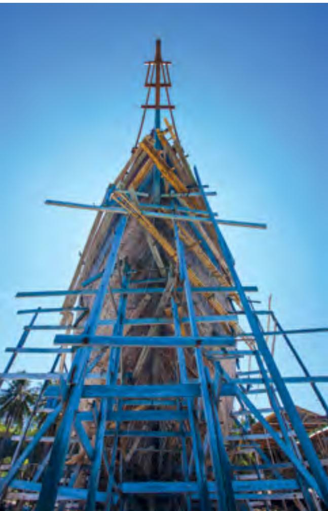
⚡ Anjungan atau *Anjong* (bahasa Bugis) atau ujung perahu pinisi berbentuk segitiga di bagian depan kapal yang digunakan sebagai penyeimbang dan membantu mengangkat tiga layar pendukung.
