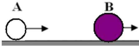
Benda A dengan kecepatan  $10 \text{ m.s}^{-1}$  berjalan di belakang B yang sedang bergerak dengan kecepatan  $4 \text{ m.s}^{-1}$ . Jika massa A = 20 kg dan massa B = 25 kg. Jika tumbukannya lenting sempurna dan kecepatan benda B setelah tumbukan  $8 \text{ m.s}^{-1}$  maka kecepatan benda A setelah tumbukan adalah ....
