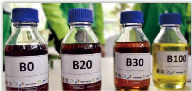
Gambar sampel biodiesel sesuai besaran campuran biodiesel di dalam BBM jenis solar
