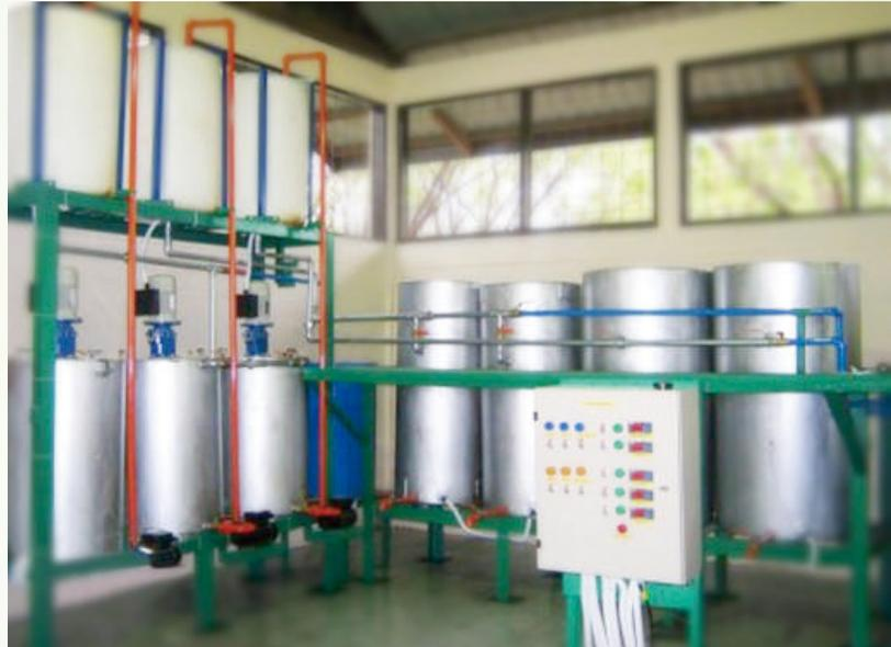
Gambar Alat Pembuat Biodiesel Skala Industri (120 L)
