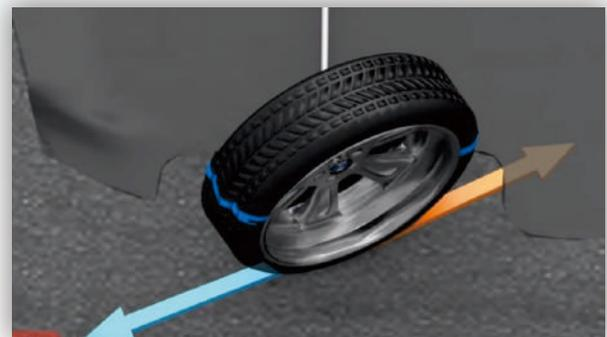
Gambar 10. Konsep Anti-Selip = Kecepatan Rotasi Lurus dengan Kecepatan Translasi
