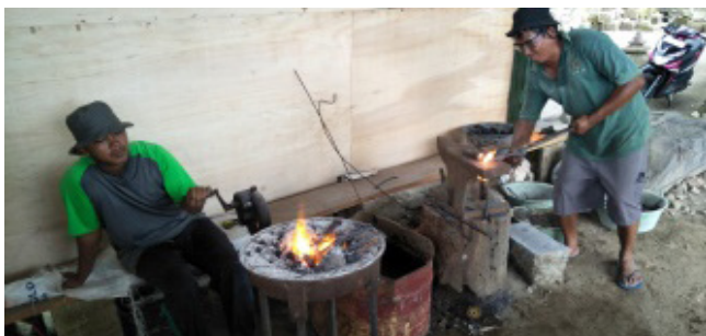
Gambar 16. Pembuatan angkur dan atau hak
