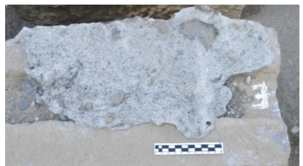
Gambar 8. Temuan semen Portland Cement pada salah satu blok batu luar pagar sisi barat (Foto: dok. BPCB DIY)
