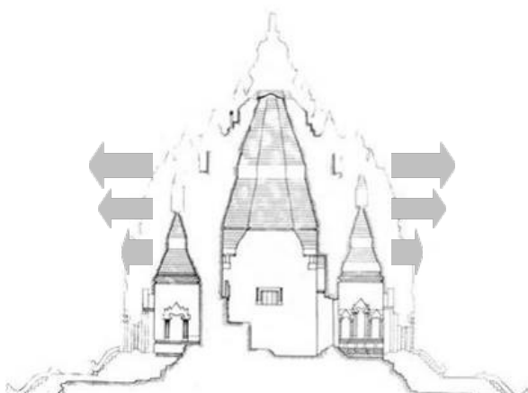
Gambar 11. Potensi orientasi pergerakan struktur bangunan Candi Kalasan. (Sumber: Dok. BPCB DIY)
