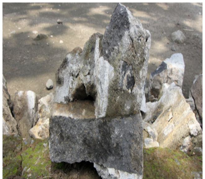
Gambar 28. Batu rusak akibat semen. (Foto: Dok. BPCB DIY)
