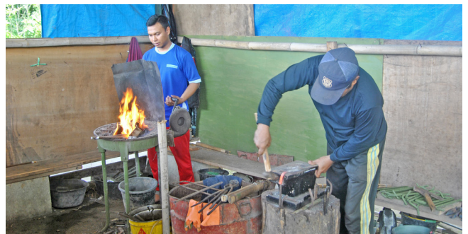
Gambar 19. Kegiatan pembuatan hak dan angkur. (Foto: Dok. BPCB DIY)
