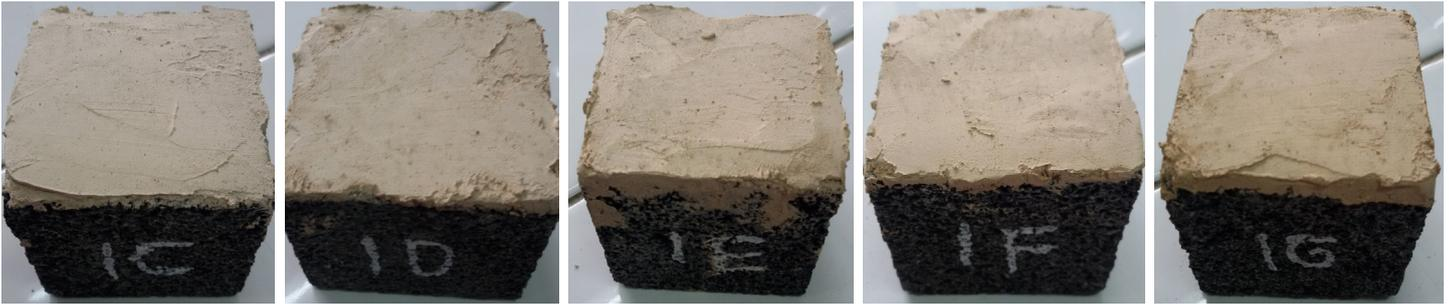
Gambar 2. Pengaruh fraksi lempung terhadap warna bahan yang dihasilkan. C (3 gr), D (5 gr), E (7 gr), F (10 gr), G (15 gr) dengan ukuran partikel 250 mesh.
