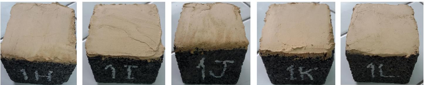
Gambar 3. Pengaruh fraksi kalkopirit terhadap warna bahan yang dihasilkan dengan ukuran partikel 250 mesh. H (3 g), I(5g), J(7 g), K (10 g) dan L(15 g) dengan berat lempung 16g. Sumber: Hasil Analisis Laboratorium Kimia Analitik UGM 2017.
