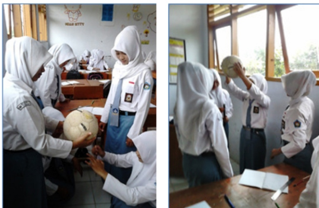
Gambar 1. Menjatuhkan bola, ketinggian ho (kiri) Gambar 2. Mengukur tinggi pantul, bola Soccer (kanan)
