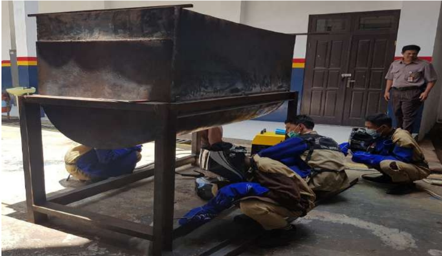
Gambar 63. Proses Pembuatan Instalasi Pembuatan Pakan Ternak Sapi oleh Peserta Didik pada Mata Pelajaran Teknik Pengelasan
