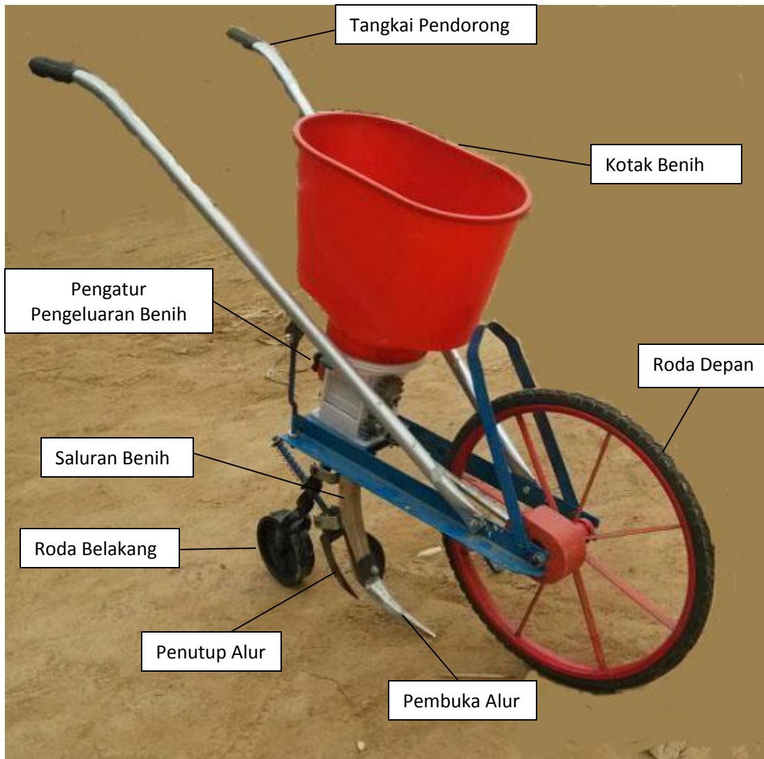
Gambar 4 : Bagian Utama Alat Penanam Jenis Semi Mekanis
