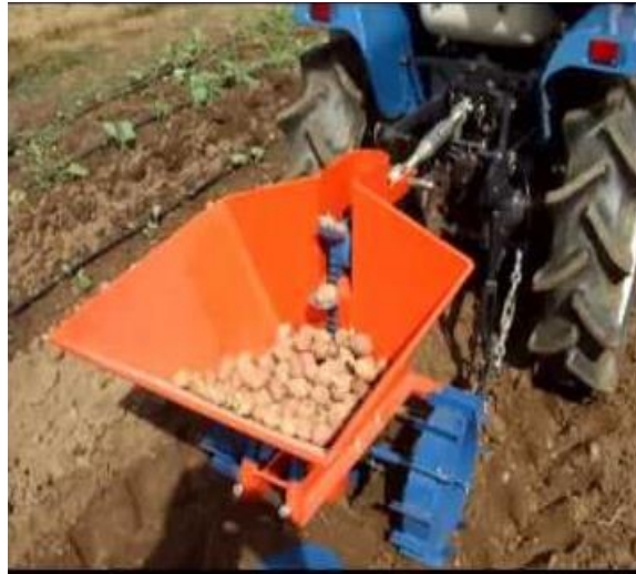
Gambar 24: mesin tanam kentang menggunakan konveyor satu jalur
