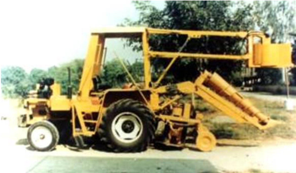
Gambar 51: Contoh wholestalk harvester yang dikembangkan oleh MERADO (CMERI)
