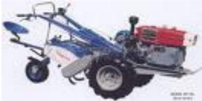
**Gambar 10 : Traktor Roda Dua dilengkapi bajak rotary**
