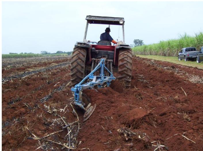
Gambar 41 : Mengolah Tanah dengan Bajak Piring
