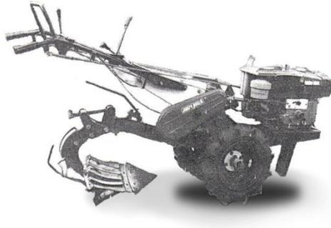
Gambar 2 : Posisi bajak pada traktor tangan
