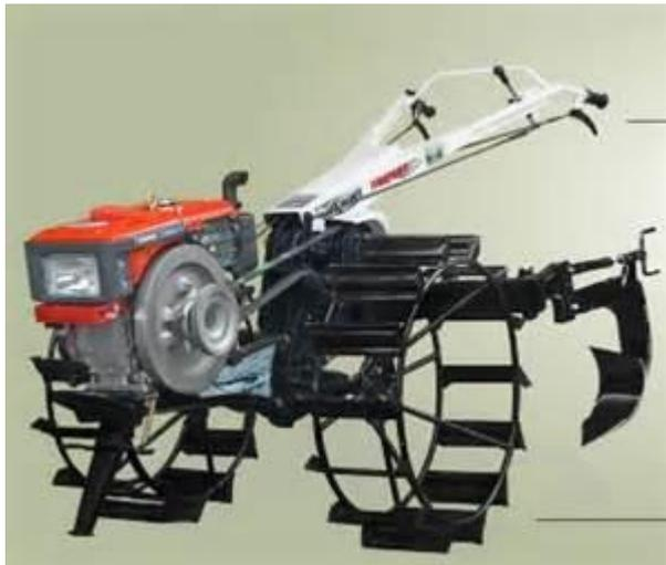
Gambar 5 : Traktor Roda Dua dilengkapi Bajak Singkal
