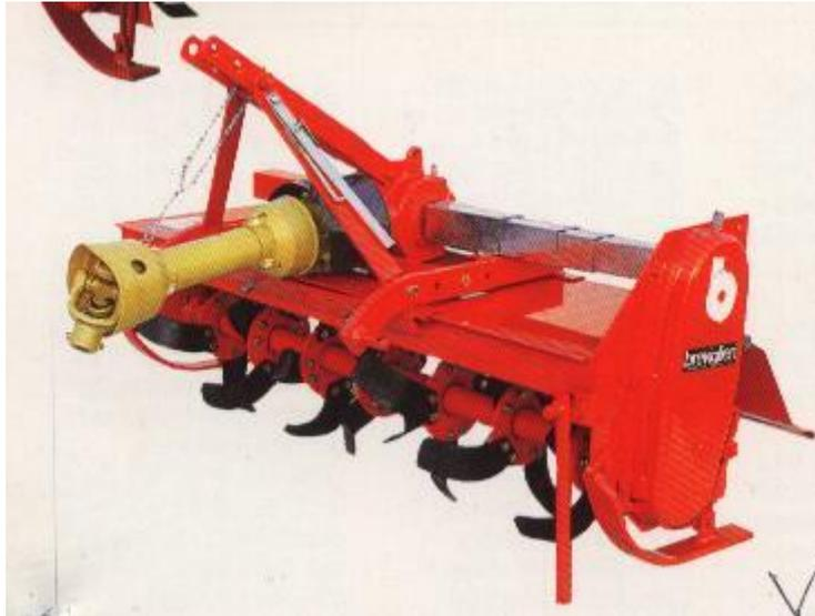
Gambar 62 : Bajak Rotari Tipe Tarik Pisau Lengkung Berpenggerak PTO
