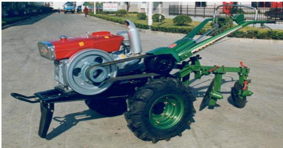
**Gambar 6 : Traktor Roda Dua dilengkapi Bajak Piringan**
