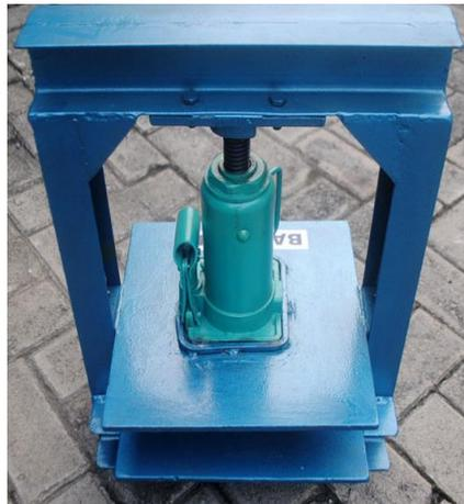
Gambar 6. Alat press hidrolik
