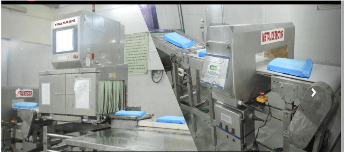
Gambar 89. Pengecekan surimi menggunakan *metal detector*
