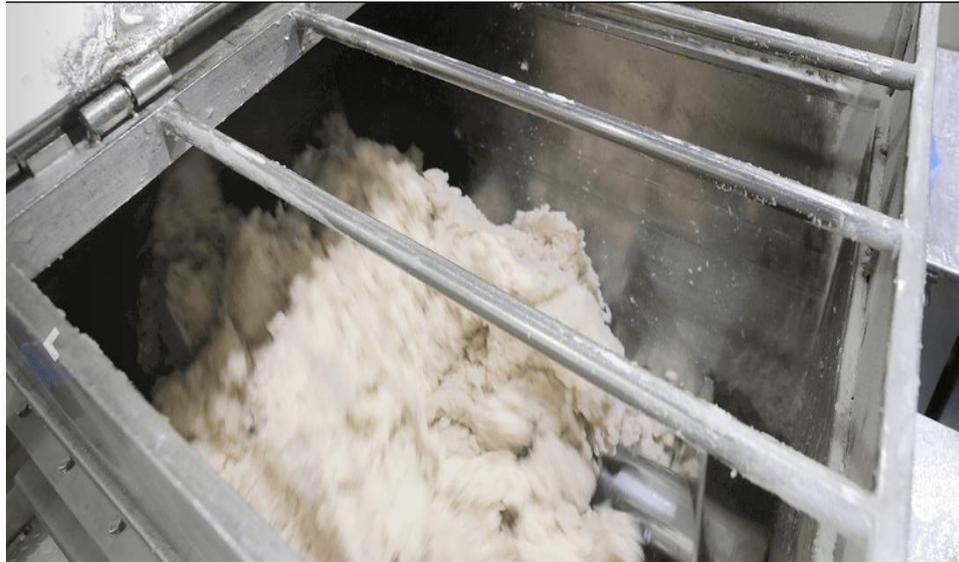
Gambar 15. Proses pencampuran dengan *cryoprotectant*
