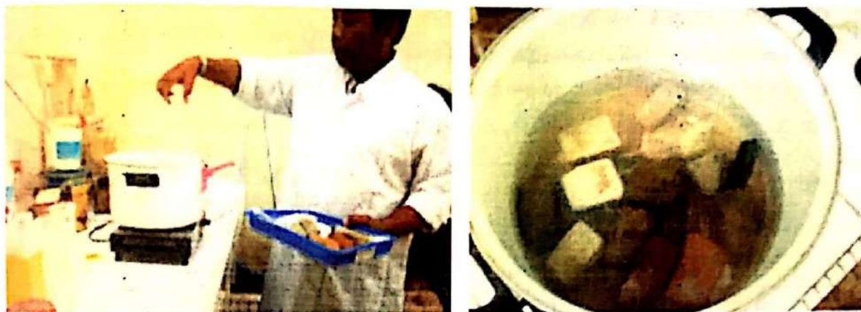
Foto.2 Perebusan sampel batuan selama 2 jam
