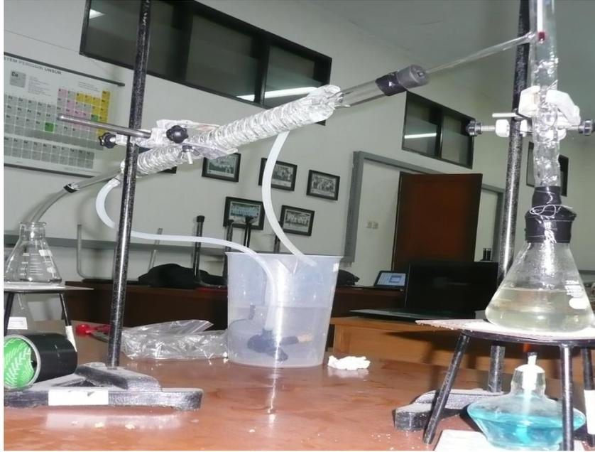
Gambar 2.9. Alat Destilasi Bioetanol skala Laboratorium
