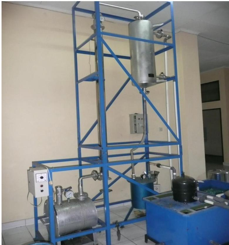
Gambar 2.8. Alat Destilasi Bioetanol skala UKM
