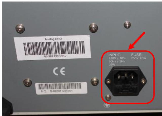
Gambar 4. 1. Informasi kebutuhan tegangan kerja pada oscilloscope
