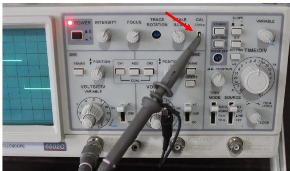
Gambar 5. 1. Menempatkan probe pada posisi kalibrasi
