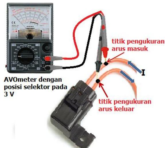
Gambar 31. Pengukuran rugi tegangan pada sekering
