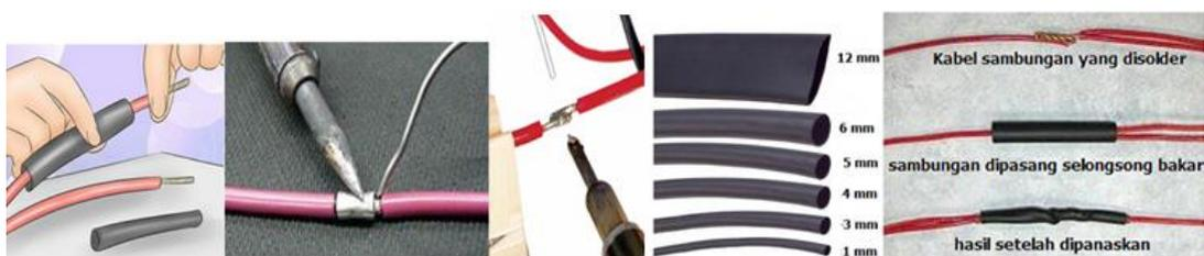
Gambar 28. Menyambung kabel
