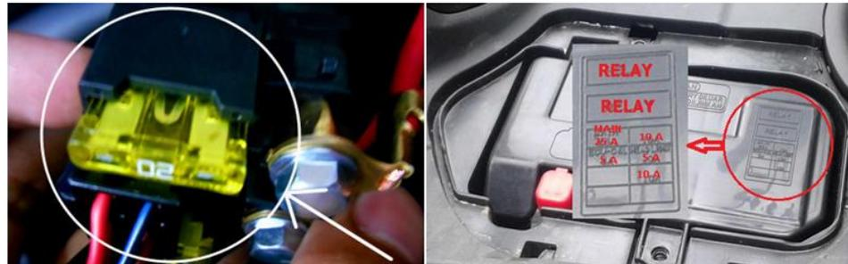
Gambar 18. Informasi spesifikasi ukuran sekering langsung pada sekering dan tutup rumah sekering
