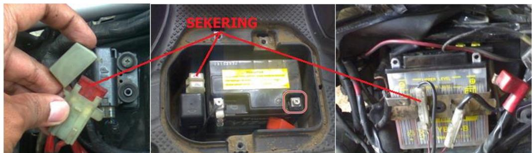
Gambar 16. Lokasi sekering pada rangkaian kelistrikan sepeda motor
