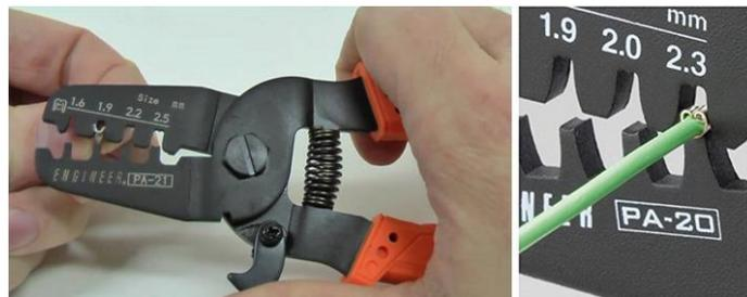
Gambar 29. Memasang sepatu kabel
