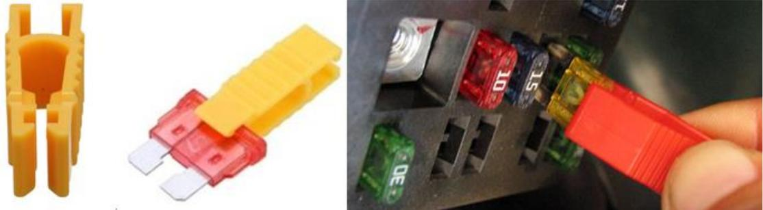
Gambar 15. Pencabut sekering tipe Blade
