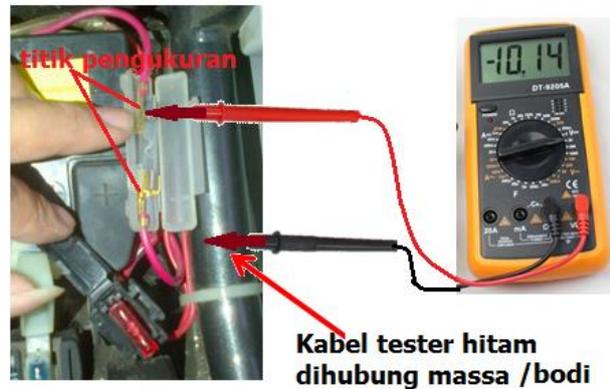
Gambar 40. Pengukuran tegangan pada sekering
