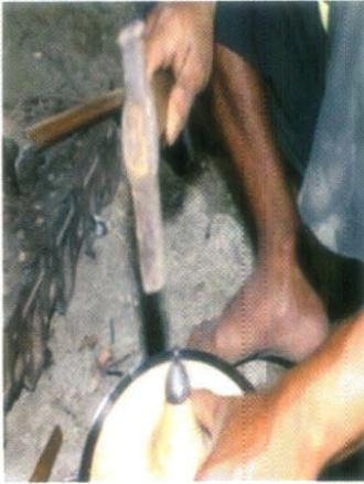
Foto 17 : Pemasangan besi penutup kepala gasing
