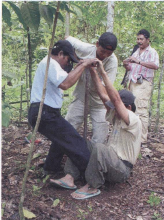
Foto 23: Pengeboran yang dilakukan pada permukaan tanah guna pengambilan sampel tanah untuk analisa fosil polen/ palinologi di laboratorium
