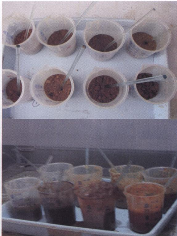
Foto 25 dan 26: Sampel tanah dan pencucian dengan HCL dan HF
