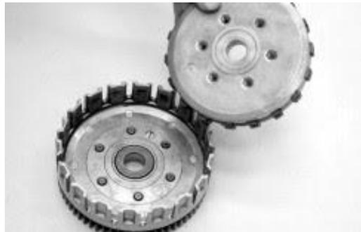
Gambar 2.1 Unit Kopling dengan Lifter Plate sudah terlepas.
