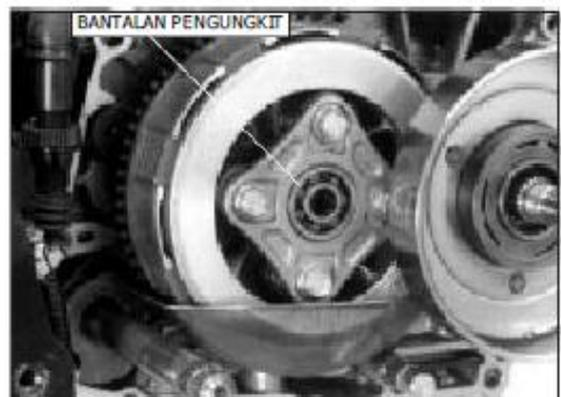
Letakkan gear holder antara roda gigi primer dan roda gigi kopling yang digerakkan seperti pada gambar. Lepaskan mur pengunci kopling manual dengan menggunakan lock nut wrench.
