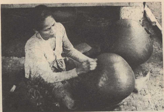
Menghaluskan gentong dengan kerok bambu
