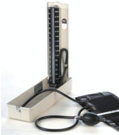
Gambar 64 Mercurial Sphygmomanometer/ Tensi meter air raksa
