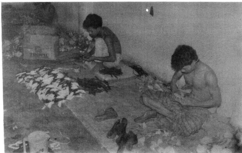
Gambar 14 Para Pekerja Sedang Memasang Kap Sandal Wanita
