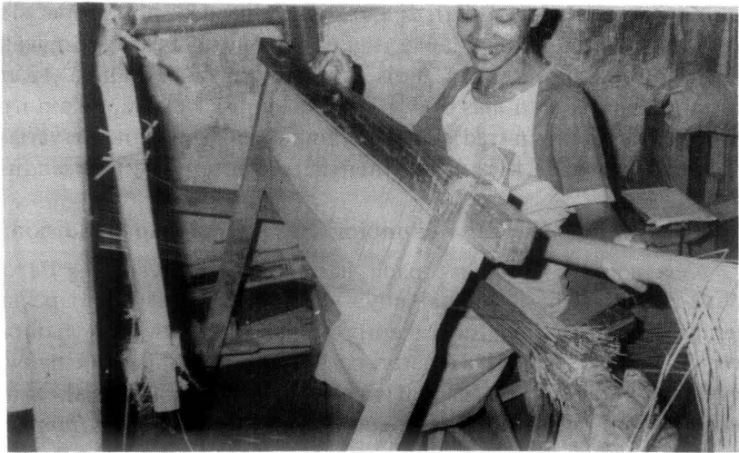
Gambar 33 Memasukkan Tropong ke Sela-sela Benang
