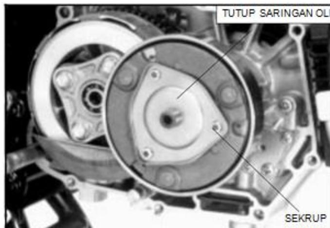
Gambar 2.25 Saringan Oli pada Kopling otomatis
