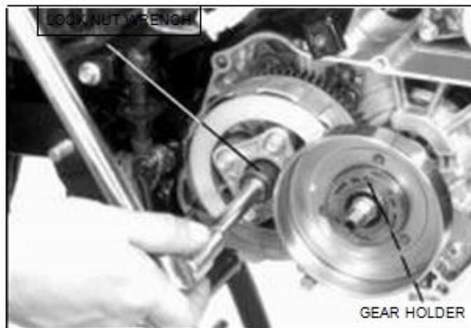
Gambar 2.29. Melepas mur kopling otomatis
