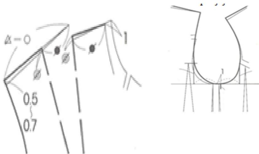
Gambar 32 : Menggambar Saku dan Menentukan Posisi Akhir Kup
