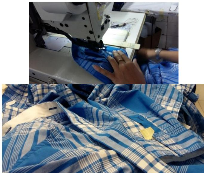
*Gambar 6. 29: Membuat Lubang kancing Dengan Mesin*
