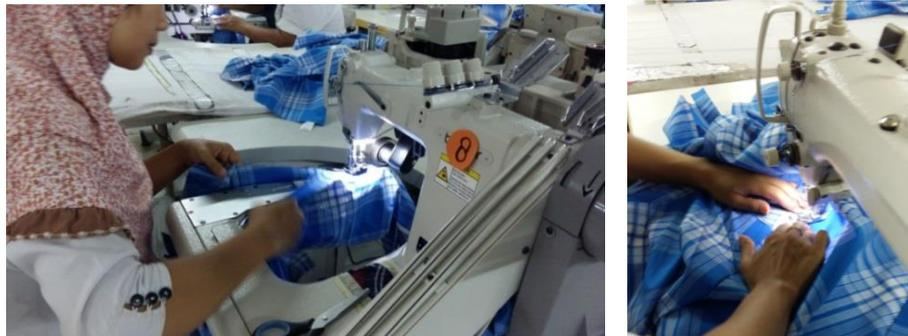
*Gambar 6. 26: Memasang Lengan Pada Bagian Badan*
