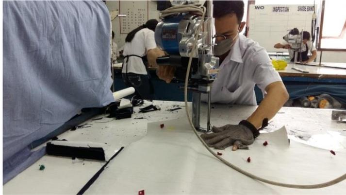
*Gambar 1. 2: Sarung Tangan Untuk Operator potong*
