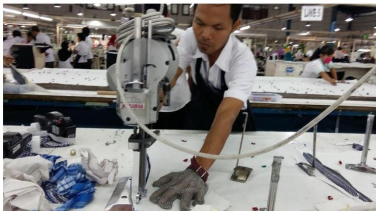
*Gambar 4. 12: Memakai Sarung Tangan Besi Dalam Pemotongan*
