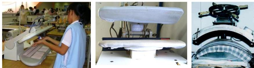
Gambar 6. 12: Mesin press (*Pressing*)
