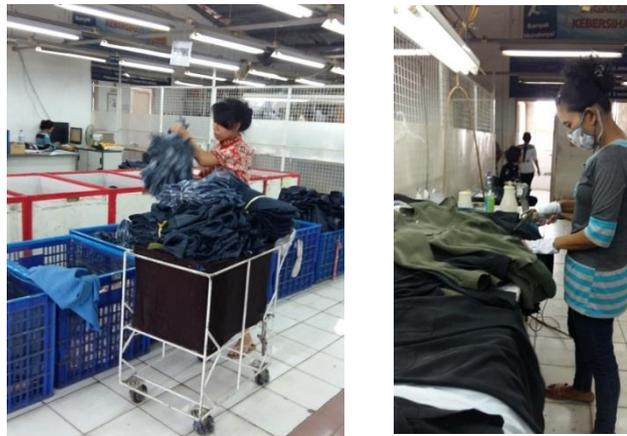
Gambar 8. 2: Melakukan Pemeriksaan Bagian Fusing
