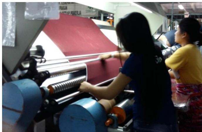
Gambar 4. 4: Mesin Pemeriksa kain (*Clotch Inspection Machine*)
