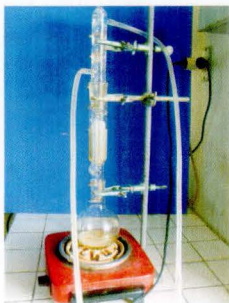
Gambar 33. Metode pengambilan minyak cengkeh dengan cara ekstraksi pelarut
