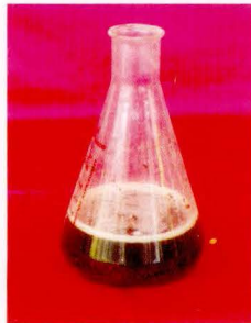
Gambar 25. Proses ekstraksi tembakau dengan pelarut metanol - asam asetat
