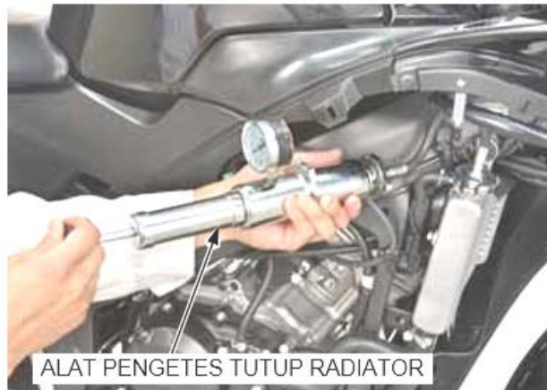
Gambar 1.4. Memeriksa kebocoran sistem pendingin
