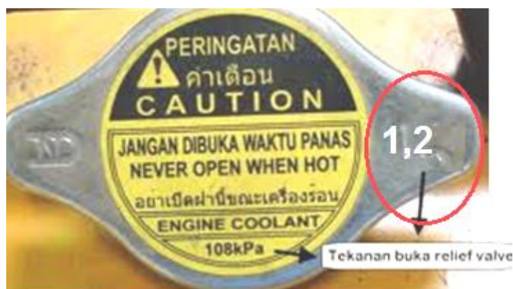
Gambar 2.38. Tekanan buka tutup radiator
