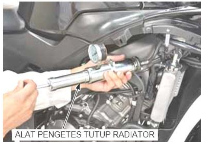
Gambar 2.39. Mengetes kebocoran system pendingin
