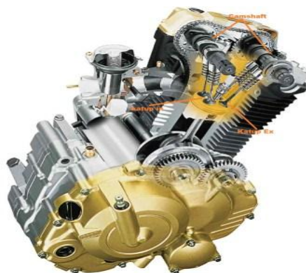
Gambar 3. c. 3). c). Penggerak katup Jenis DOHC
