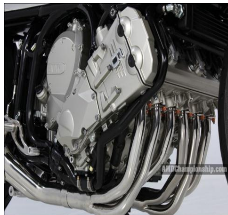
Gambar 2. c. 1). Konstruksi Blok Silinder Sebaris/Inline
