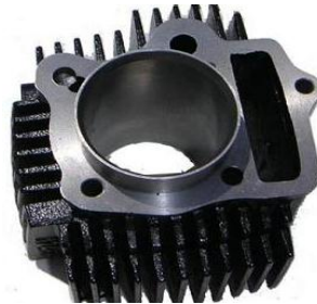
Gambar 3. b. 2). a).Blok Silinder Bahan Besi Tuang
