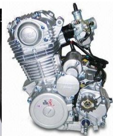
Gambar 2. c. 1). Konstruksi Blok Silinder Sebaris/Inline
