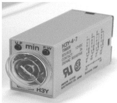
Gambar 51. Konstruksi TDR
